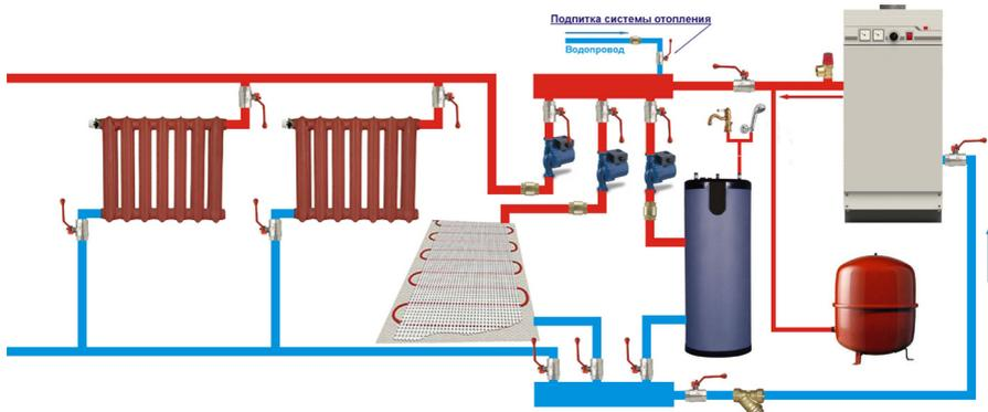
Рисунок 6. Схема подключения котла с общим гидравлическим коллектором.
