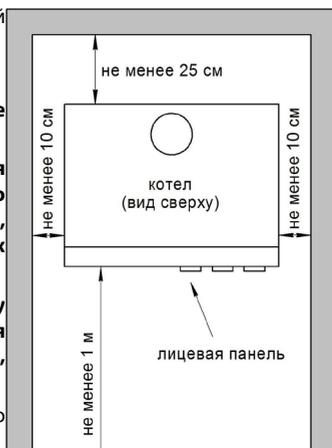
Рис. 5 – Схема установки котла
