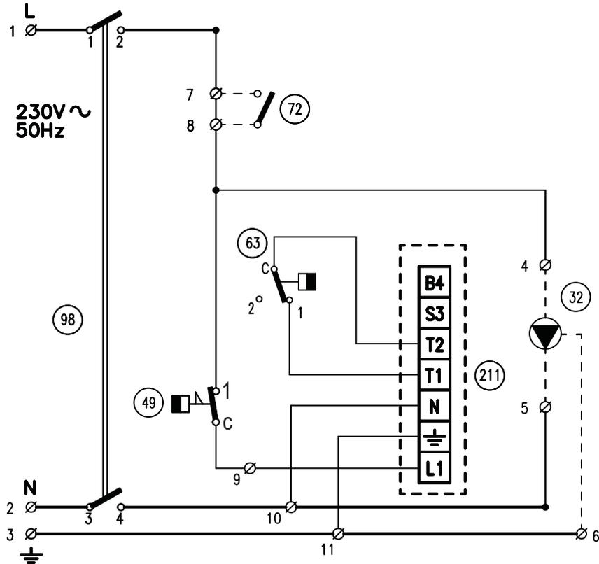
рис. 7 - Принципиальная электрическая схема EL-DB N 32 ч 78
