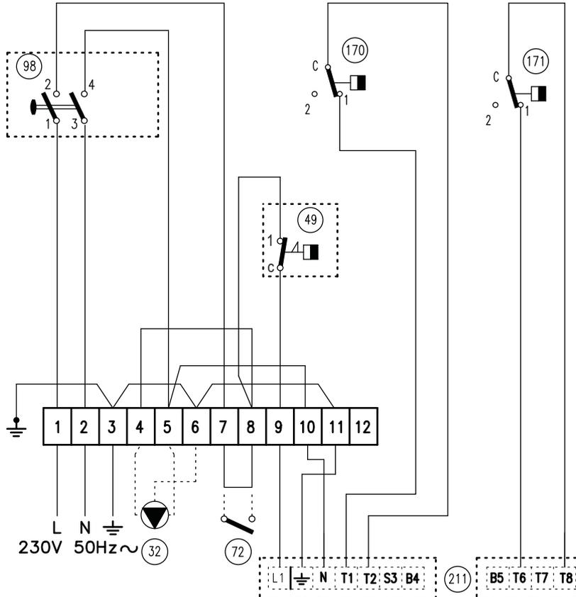
рис. 10 - Схема электрических соединений EL-DB N 95
