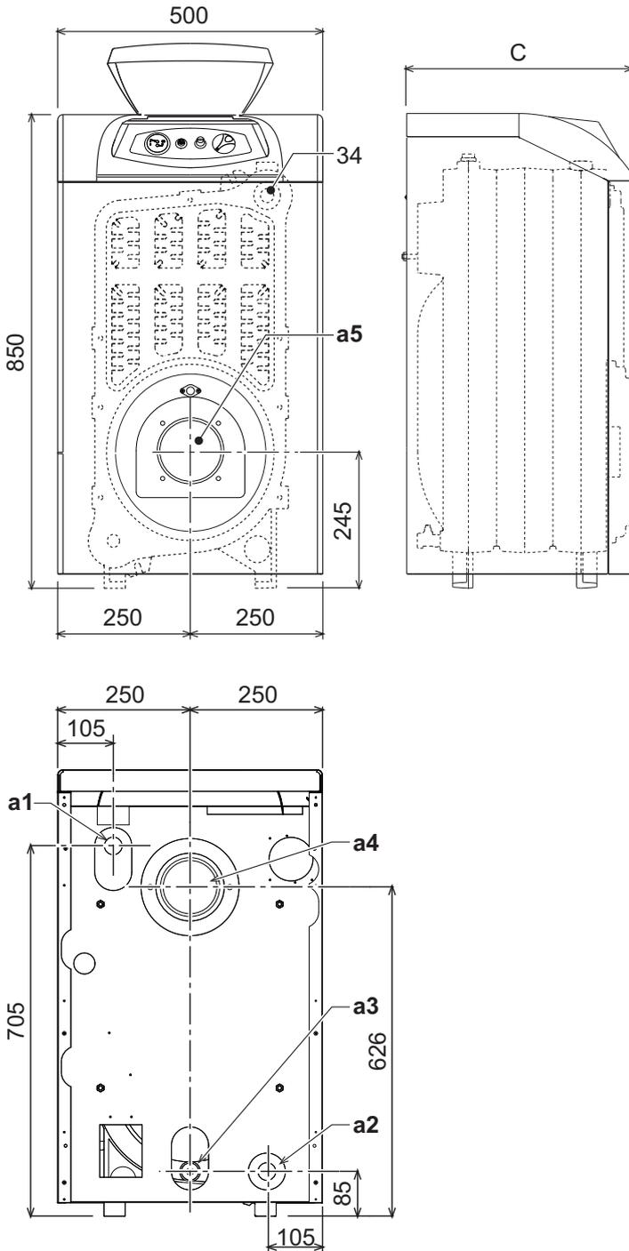
рис. 5 - Размеры, присоединения и основные элементы котла
