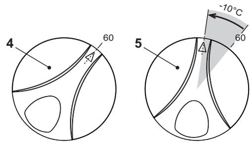
рис. 3 - Регулирование температуры модели EL-DB N 95
