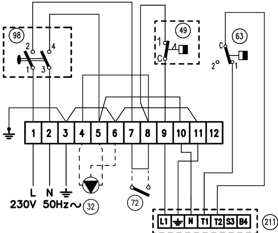
рис. 8 - Схема электрических соединений EL-DB N 32 ч 78
