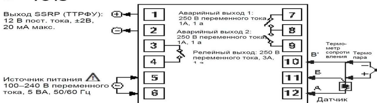
Рис. 9. Электрическая схема температурного контроллера.
