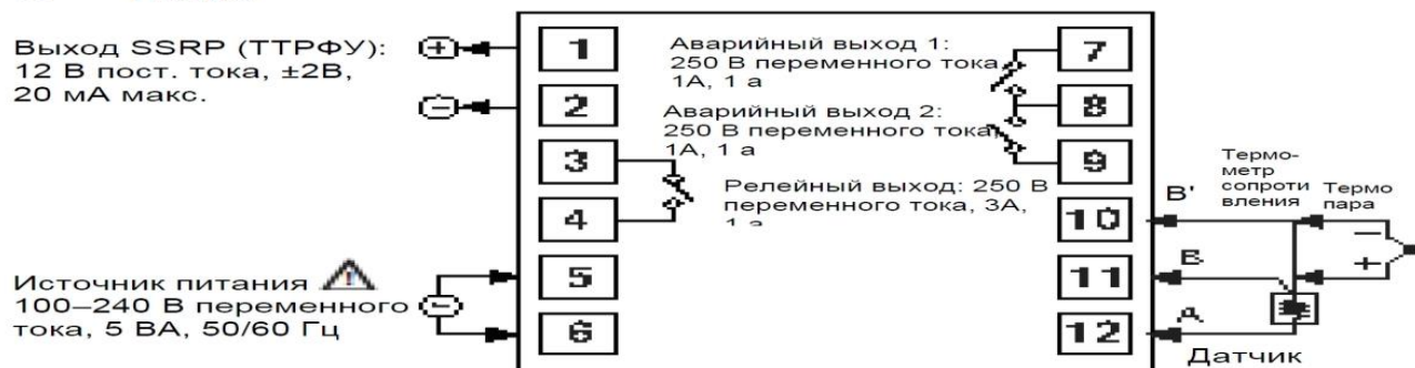
Рис. 9. Электрическая схема температурного контроллера.
